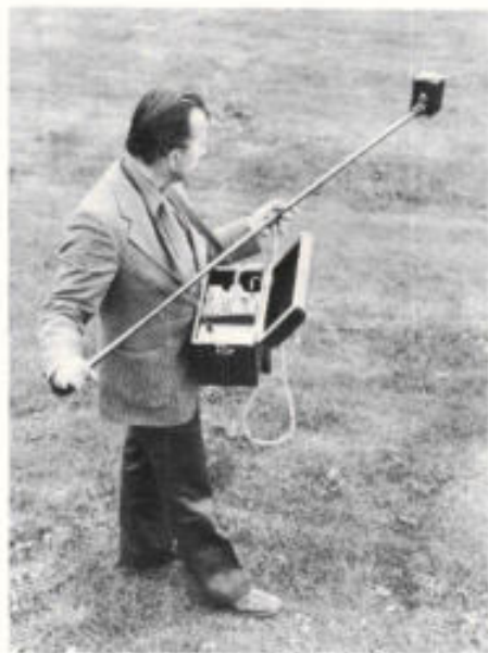
Afb. 10. In de interpretatie van satellietfoto's van het aardoppervlak zijn in het veld gemeten reflectiefactoren van bodem en vegetatie nodig. Deze afbeelding laat een draagbare cosinus-gecorrigeerde reflectiemeter tijdens het gebruik in het veld zien.
